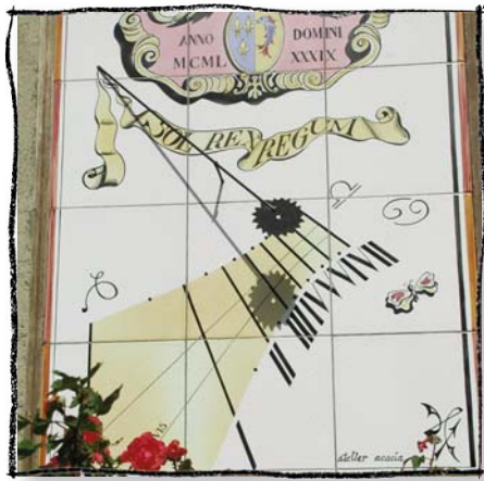
Cadran déclinant du soir 0^\circ < D < +90^\circ Mont-Dauphin (Hautes-Alpes 05) réalisation Atelier Acacia. Photo Alain Ferreira.
